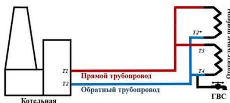
Рисунок 2 – Двухтрубная система теплоснабжения.
