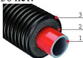
Рисунок 1 – Труба Флексален: 1) полибутиленовая труба; 2) изоляция из вспененного полиэтилена; 3) кожух
