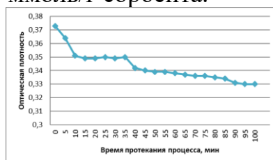
Рисунок 2 – Зависимость оптической плотности от времени по отношению к \text{Cu}^{2+}
