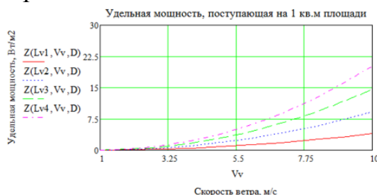
Рисунок 1 – Зависимость удельной мощности на 1 м 2 площади острова от скорости ветра при длине разгона волны 1, 2, 3 и 4 км
